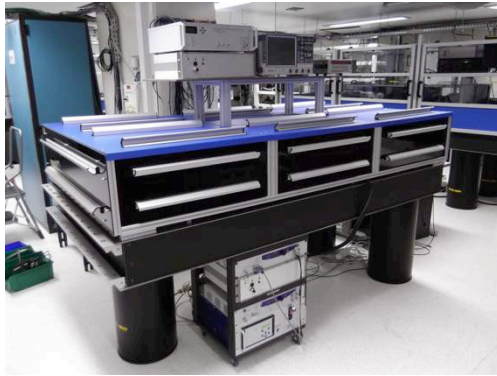
Fig. 1 : Nouveau front end du LULI2000 : un système hybride entre espace libre et fibre optique télécom et à cristaux photoniques.
